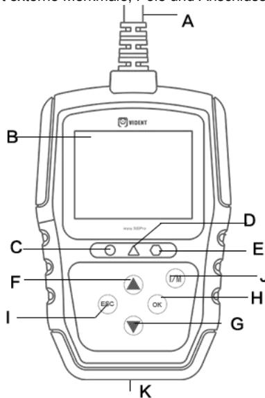
**A OBDII-Kabel** - stellt die Verbindung zur Fahrzeug-DSS her.
